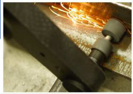
GS08-00 Przystawka kątowa do szlifowania narzędziami trzpieniowymi
