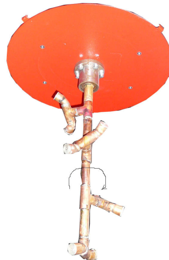
System automatycznego oczyszczania filtra Fot.3
